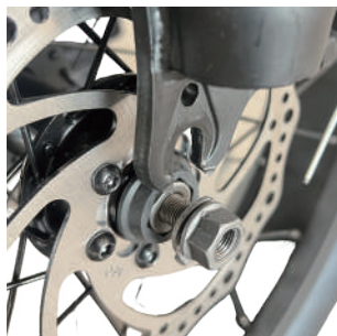
4. Achse und Sicherheitshaken ausrichten.
