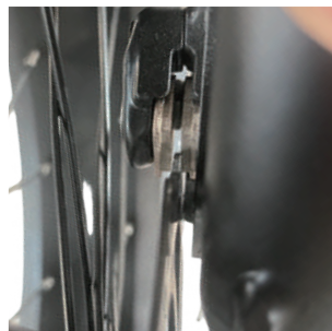
3. Bremsscheibe in den Bremssattel einsetzen.
