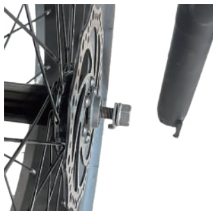
1. Mutter vollständig lösen.
