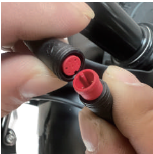
4. Pfeile an den Steckverbindern ausrichten.
