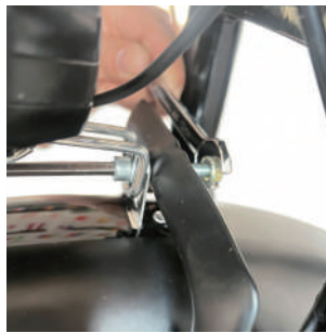
2. Schrauben durch Kotflügel und Scheinwerfer einführen.
