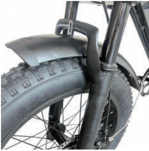
1. Schutzblech in die Gabel einsetzen.
