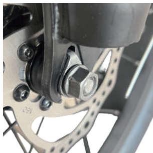
4. Achse und Sicherheitshaken ausrichten.
