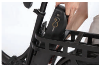
1. Halten Sie die Batterie mit beiden Händen fest.
