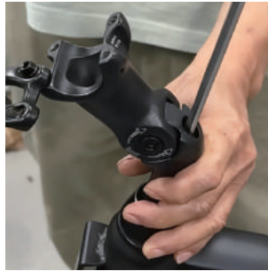
2. Align stem and tighten top bolt.
