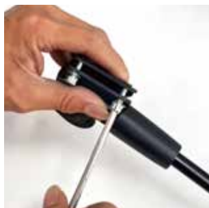
1. Rimuovere le due viti dal cavalletto laterale.
