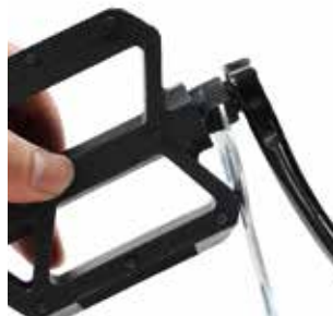
3. Serrare completamente il pedale con un attrezzo.
