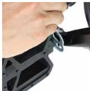
5. Serrare completamente il pedale con un attrezzo.
