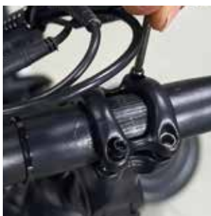
5. Rimontare la vite e il tappo superiore.
