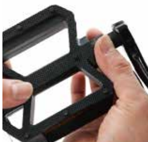
2. Avvitare il pedale sinistro in senso antiorario.
