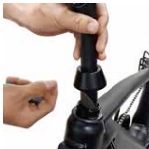
1. Inserire l'attacco manubrio nel tubo sterzo.
