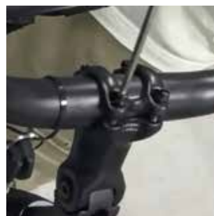
6. Regolare l'angolazione del manubrio e serrare saldamente.
