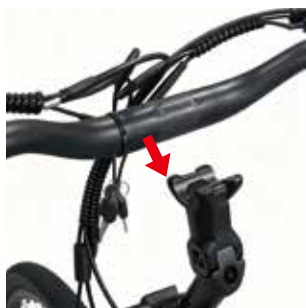
4. Montare il manubrio nel supporto.
