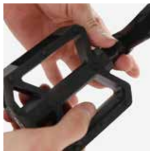
4. Avvitare il pedale destro in senso orario.
