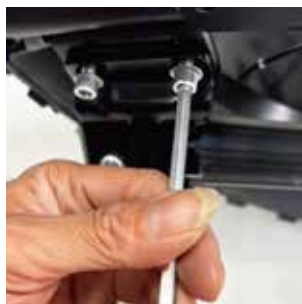
2. Allineare il cavalletto laterale al telaio e montare le viti.
