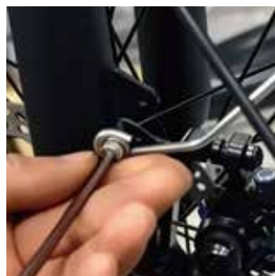
6. Usare le viti per fissare il supporto del parafrangente.
