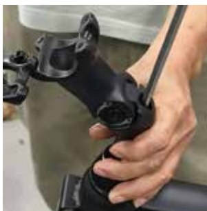
2. Allineare l'attacco manubrio e serrare la vite superiore.
