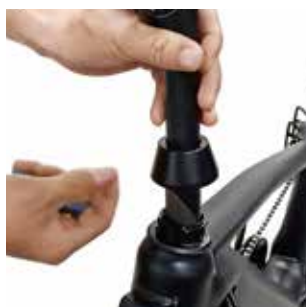
1. Inserte la potencia en el tubo de dirección.
