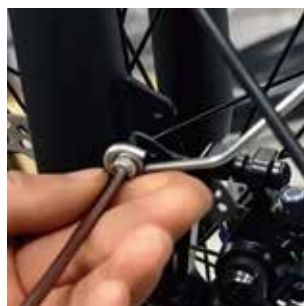
6. Use los tornillos para fijar el soporte del guardabarros.
