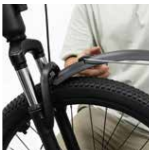
2. Coloque el guardabarros sobre la rueda.
