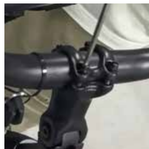
6. Ajuste el ángulo del manillar y apriete firmemente el tornillo.
