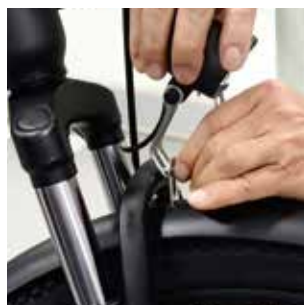
3. Fije el guardabarros y la luz con el tornillo.
