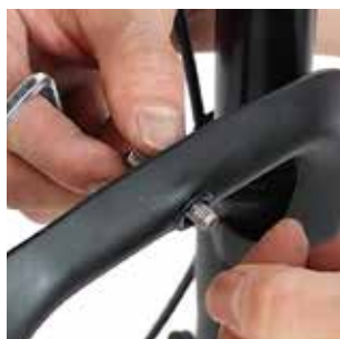
1. Retire el tornillo de la horquilla.
