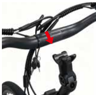
4. Utilice la tapa superior y el tornillo retirados para fijar el manillar.
