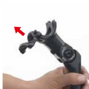
3. Coloque el manillar en el soporte del tubo de dirección.
