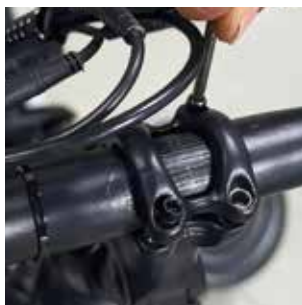
5. Alinee la potencia hacia delante y apriete el tornillo superior.
