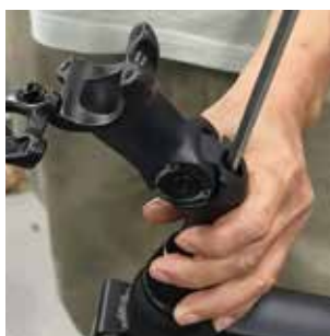
2. Afloje el tornillo y retire la tapa superior del tubo de dirección.
