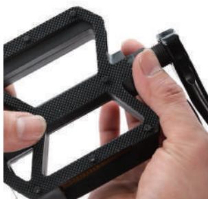
2.L: Zum Einbauen gegen den Uhrzeigersinn drehen.
