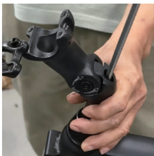
2. Richten Sie den Vorbau aus und ziehen Sie die obere Schraube fest.
